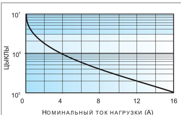
Электрическая долговечность при ном. нагрузке AC1 (+85 °C)
