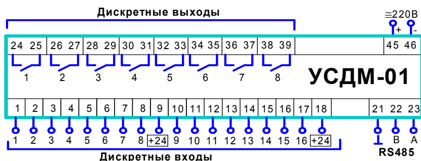
Рисунок 3 - Схема подключения УСДМ-01
