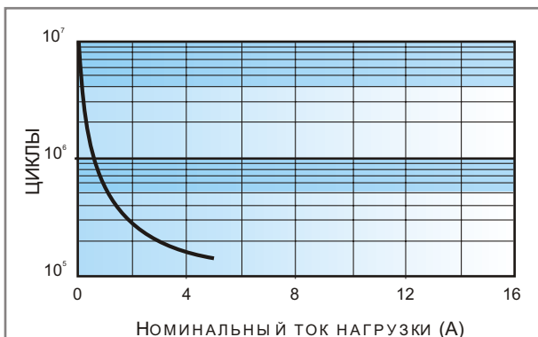
Электрическая долговечность при ном. нагрузке AC1
